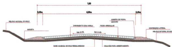
SECÇÃO TRANSVERSAL PAVIMENTAÇÃO SEM ESCALA
